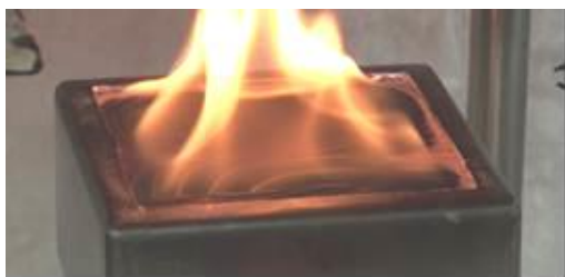
スギ集成材の燃焼性試験
