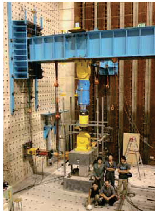
超高強度コンクリート柱の載荷実験
