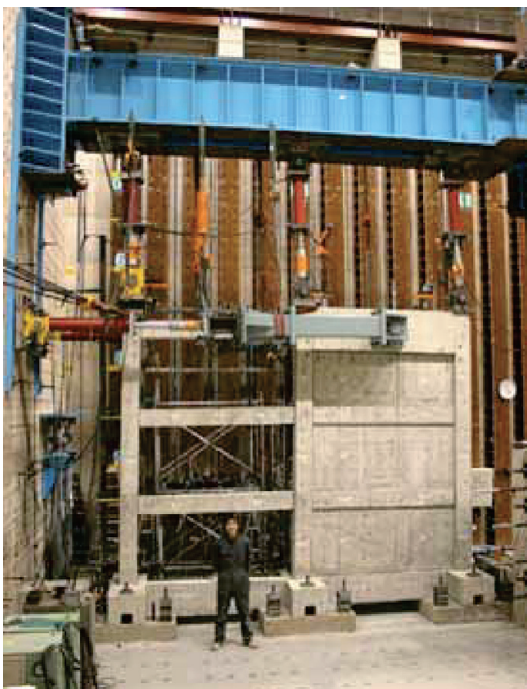
耐震壁モデルの載荷実験
