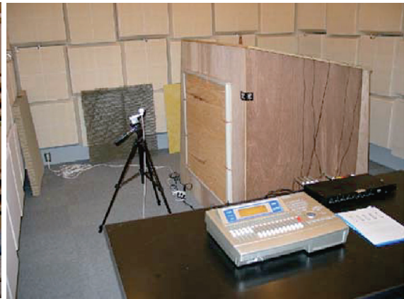
床衝撃音を制御するための遮音構造体の開発を目的とした模型実験
