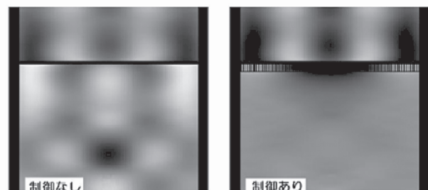
床衝撃音の低減効果 (シミュレーション)
