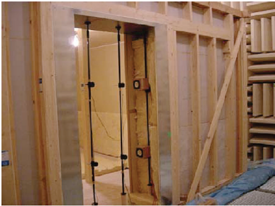
アクティブノイズコントロール (ANC) による開口部からの騒音制御の実験
