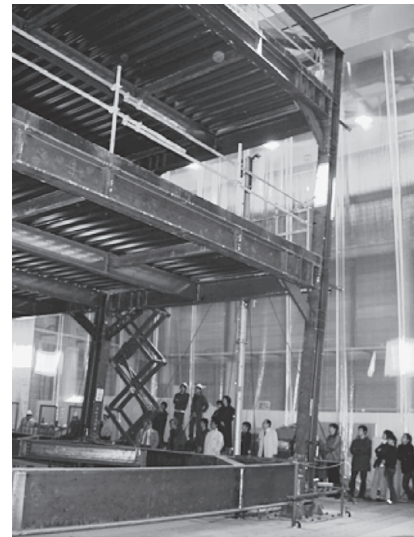
油圧装置で加力して強さや壊れ方を観察・計測する
